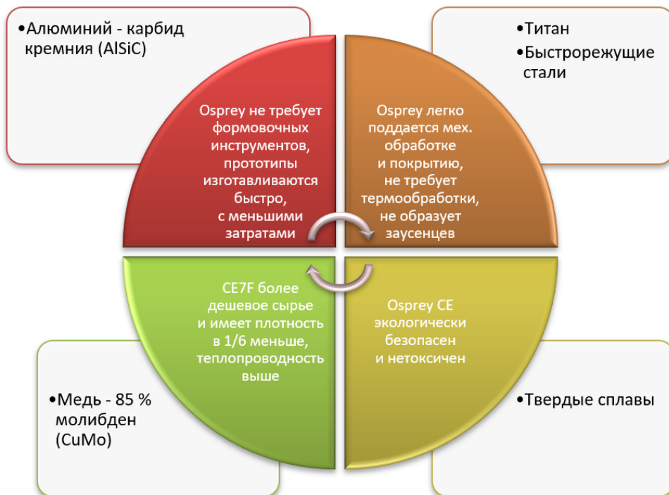
Рис. 2. Сравнение свойств сплава Osprey® CE с существующими режущими материалами
